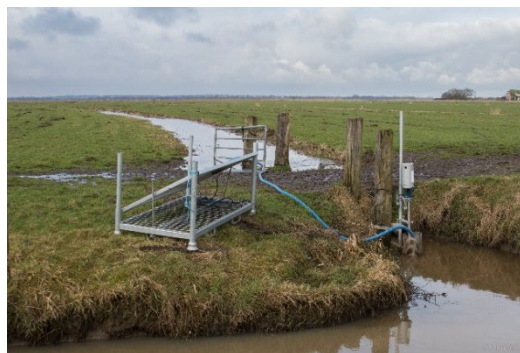
Figuur 3 Pomp op zonne-energie.
