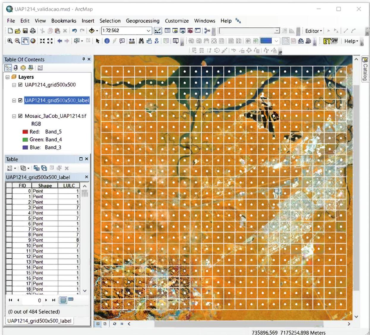
**Figura 2.** Janela do software ArcGIS (versão 10.4.1) exibindo a grade vetorial e os pontos de referência criados pela ferramenta *Create Fishnet* para a UAP1214, utilizando a extensão do mosaico *RapidEye* em composição NIR/RE/R.
