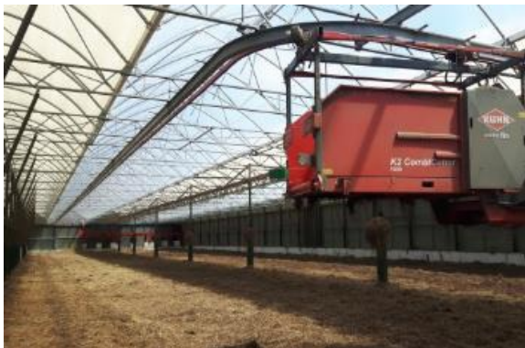
Automatisch instrooien van de nieuwe stal met maaisel De stal biedt volop ruimte aan de dieren (MP) uit natuurgebieden (MP)
