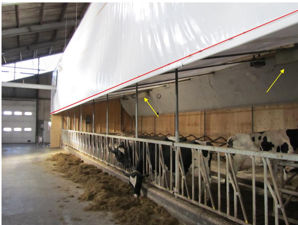
Figuur 2 Zicht op afdeling 16 van de meetunit. Het gordijn voor regeling van de luchtinlaat is omhoog. Aan de onderzijde van het gordijn zijn de meetpunten voor meting van de achtergrondconcentratie bevestigd (rode lijn). In de afdelingen zijn de twee ventilatoren voor de luchtafvoer te zien (gele pijlen) waarin zich ook de monsterpunten voor de meting van de ammoniakconcentratie in de uitgaande lucht bevinden.
